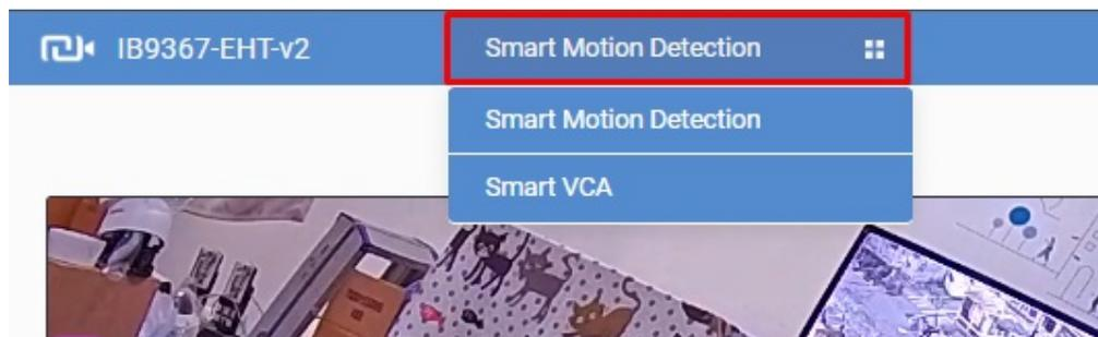
Si el dispositivo solo muestra "Detección de movimiento inteligente", solo admite esta función. Si muestra tanto Detección de movimiento inteligente como VCA inteligente, entonces el dispositivo admite ambas funciones.
