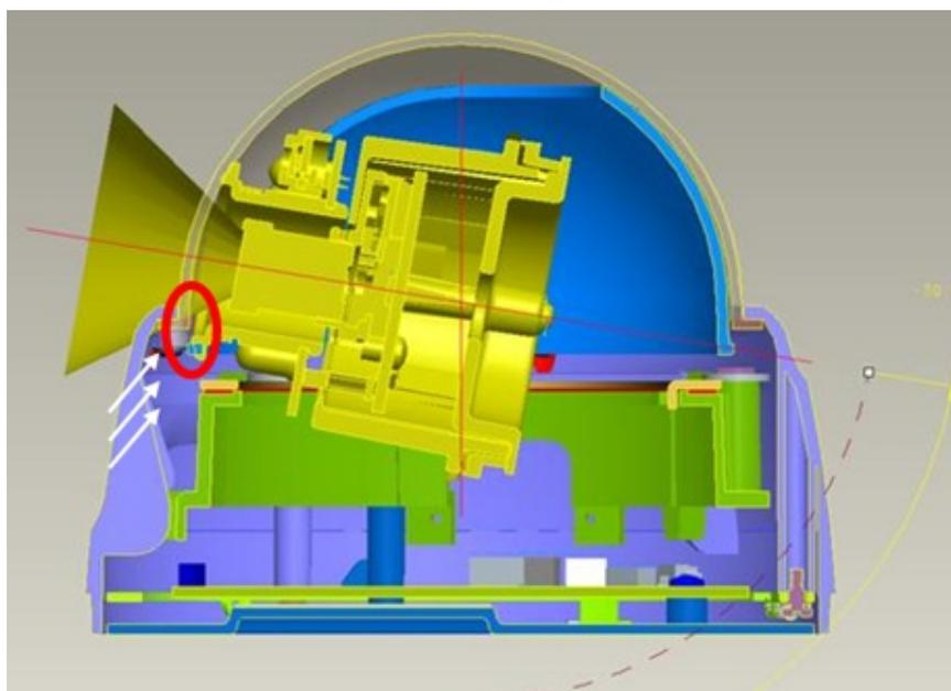
Si el ángulo de inclinación de la cámara supera el máximo especificado en el manual, la luz infrarroja se reflejará en el interior de la cámara, lo que afectará las imágenes capturadas. También puede deformar la goma de la lente, lo que permitirá que las luces infrarrojas entren en la cámara y sean detectadas por el sensor.
