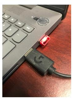
Una vez colocada la llave USB o dongle, nos va a mostrar las opciones de conexión, vamos a escoger USB
