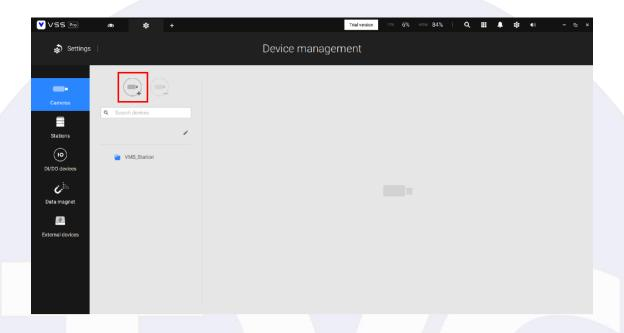
6. En automático el **VSS** realizará un escaneo de los dispositivos que se encuentren conectados en la misma red que el servidor, es aquí donde encontraremos la o las cámaras que deseamos agregar. En esta ocasión vamos a añadir la cámara **IB9387-HT-A.**
