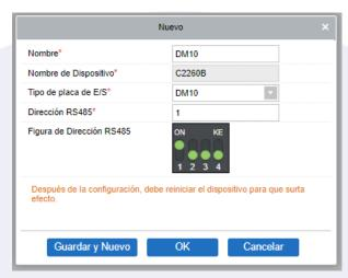
De igual manera, en el panel **C2260** viene incluido un **AUX485** el cual aumenta la capacidad de dispositivos auxiliares que se pueden conectar al panel (*Botón de emergencia, sensores de humo, haz de luz entre otros*) Para dar de alta este dispositivo, esta ventana emergente, se debe configurar de la siguiente manera:
