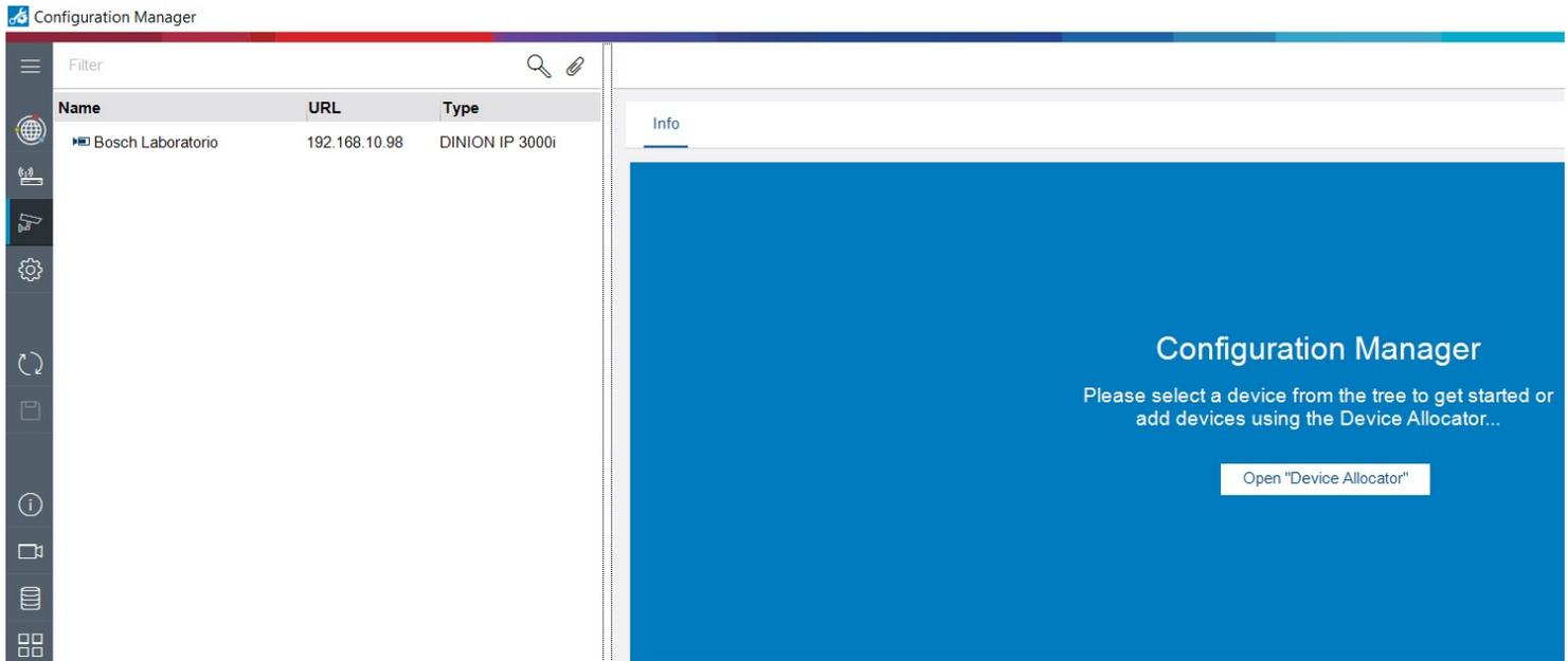
Para entrar a la interfaz WEB de la cámara nos podemos ir seleccionando sobre la cámara el botón derecho del mouse y seleccionando "Show in Web Browser" o simplemente ponemos la dirección IP de la cámara en el navegador
