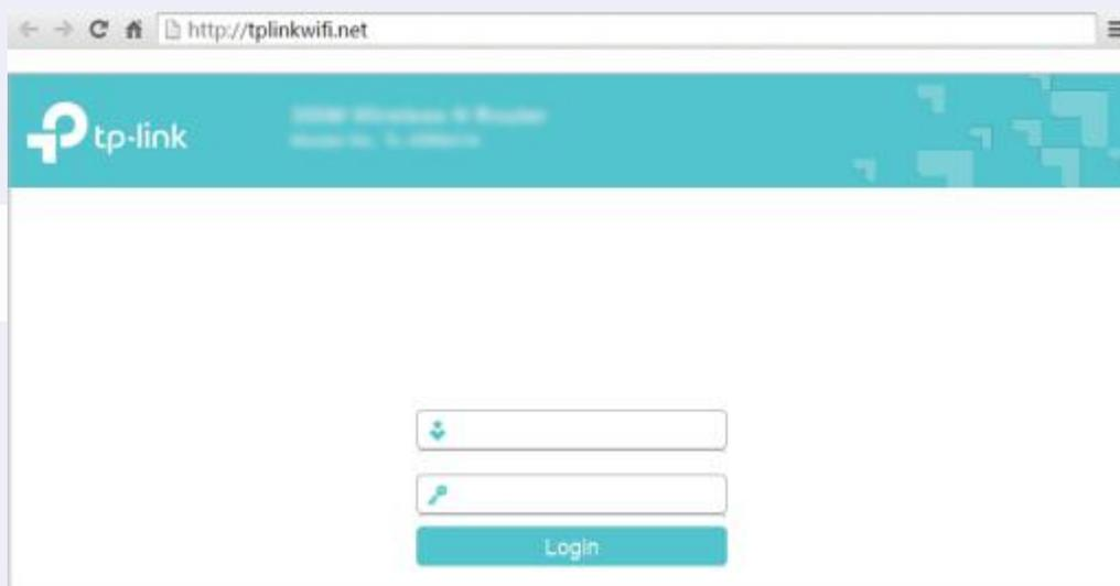
5. Después de iniciar sesión correctamente, seleccione el modo Punto de acceso y siga la Configuración rápida para completar la configuración.
