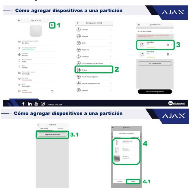
Tenga en cuenta que un dispositivo puede estar solo en una partición. Cuando se agrega un dispositivo a otra partición, se traslada automáticamente.
