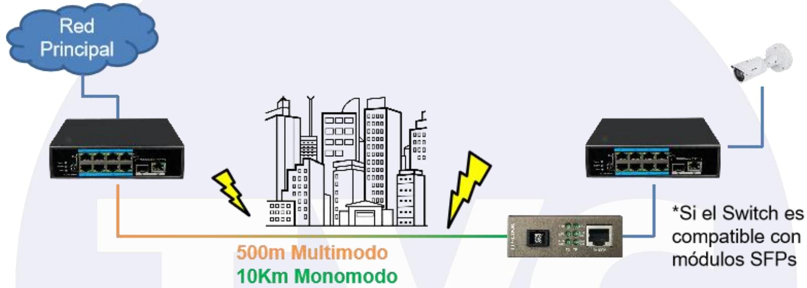
En este escenario de izquierda a derecha tenemos que la Red Principal se conecta a un Switch compatible con puertos SFP omitiendo la necesidad de usar otro Convertidor de medios (A), usando Fibra Monomodo o Fibra Multimodo pueden pasar por sus distancias respectivamente al puerto del Convertidor de Medios (B), en el que este convierte la señal a UTP para llegar a un Switch que después de este llega a una Cámara.
