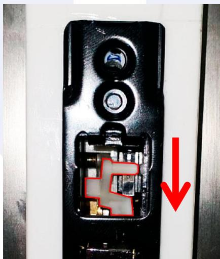
Ya que tengamos presionada la palanca sin soltarla, retiraremos una batería y colocaremos nuevamente, manteniendo en todo momento presionada la palanca, hasta escuchar un nuevo vip + 2 tonos.
