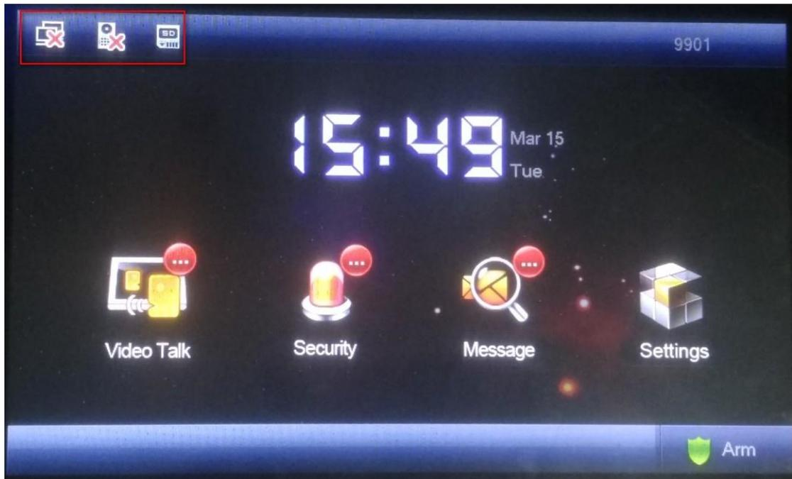
Notas: El primer icono refleja el estado de la red de VTH. el segundo icono muestra el estado del registro VTH en el dispositivo VTO. VTO y todos los VTH conectarse a este VTO se registrará en DSS automáticamente después de configurar y reiniciar dispositivos VTH y VTO.
