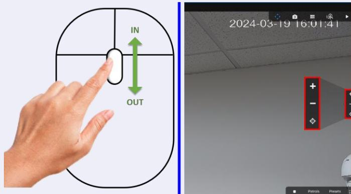
8. **Mover la cámara** para mover la cámara de un punto a otro, existen dos maneras diferentes, la primera es presionando con un clic con el botón izquierdo del mouse hacia la dirección que se quiere mover o dar un clic con el botón izquierdo del mouse en cualquier lugar de la pantalla y sin soltarlo, mover el mouse hacia la dirección que se quiere girar la cámara.
