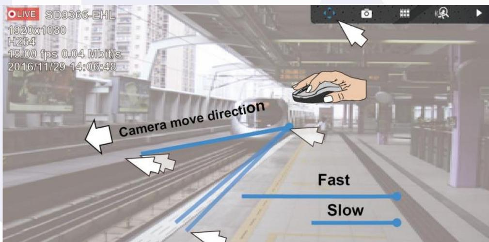
9. Configuración PTZ: dentro de este menú de configuraciones, podremos modificar los valores del iris, el enfoque, la velocidad de la cámara al realizar un movimiento y así mismo podemos generar un paneo en la cámara.
