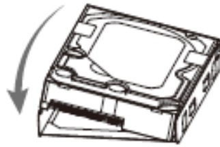
Figura 2-7 Instalar disco real
