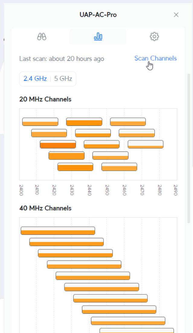
Basándote en los resultados del escaneo, elige canales que presenten la menor cantidad de interferencia y ocupación también considera ajustar el ancho de banda del canal (20 MHz vs 40 MHz en 2.4 GHz, o 20 MHz, 40 MHz, 80 MHz en 5 GHz) para minimizar la interferencia y maximizar el rendimiento.
