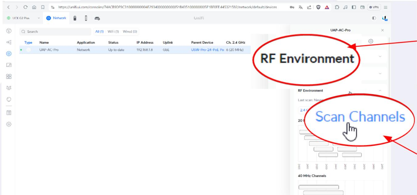
En breve se mostrará una ventana emergente donde nos indicará que las conexiones inalámbricas WiFi que existan en ese access point se suspenderán debido a que el access point utilizara el hardware para realizar un escaneo de frecuencias mediante un barrido del espectro.
