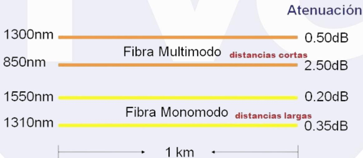
Es importante recalcar que la velocidad no lo rige el tipo de fibra si no los transceptores a los que esta conectado la fibra. Por ejemplo
