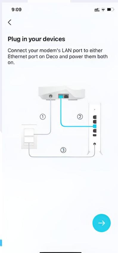
7. Conecte una de sus unidades Deco a su módem mediante un cable Ethernet y encienda ambos dispositivos.
