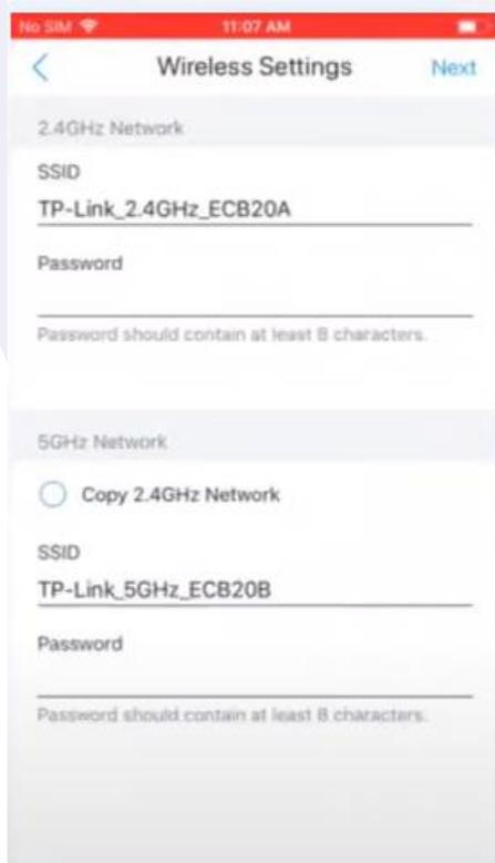
En la sección de configuración inalámbrica, ingresa el nombre de la red (SSID) para las bandas de 2.4 GHz y 5 GHz establece una contraseña segura para tu red inalámbrica.
