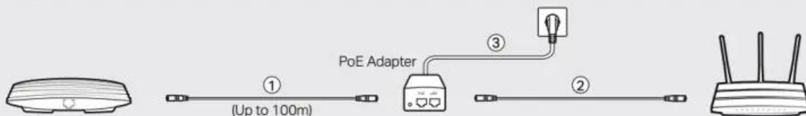
**Opción 3:** mediante adaptador de corriente (para EAP115) Enchufe un extremo del adaptador de corriente provisto en el puerto de Alimentación del EAP y el otro extremo a un tomacorriente de pared estándar.
