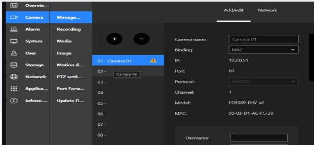
En la sección de configuración, selecciona la opción para agregar una nueva cámara IP. Introduce la dirección IP que obtuviste previamente mediante la aplicación, especifica el puerto de video como 2020 y elige el protocolo ONVIF. Luego, ingresa las credenciales de acceso de la cámara Tapo.
