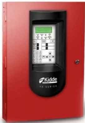
FX64RSP - Panel de Alarma Contra Incendio / capacidad de 64 puntos / 2 NACs / Rojo / 110V / Español FX-64R-SP KID1420005
