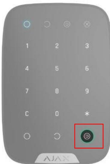
Nota: Con el KeyPad, puede armar el sistema o activar el Modo Noche sin introducir el código. Para ello, vaya a la configuración de KeyPad y habilite la función de Armar sin código
