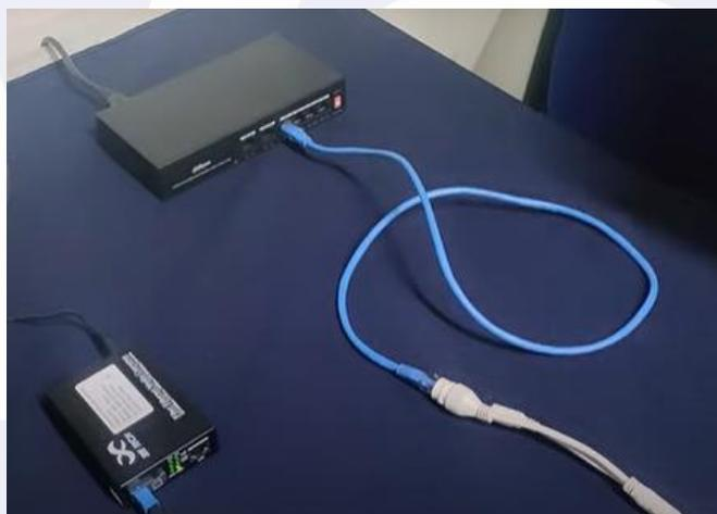
La conexion que se tiene que hacer es directamente de un puerto del Switch al puerto UTP del Convertidor de Medios (A)
