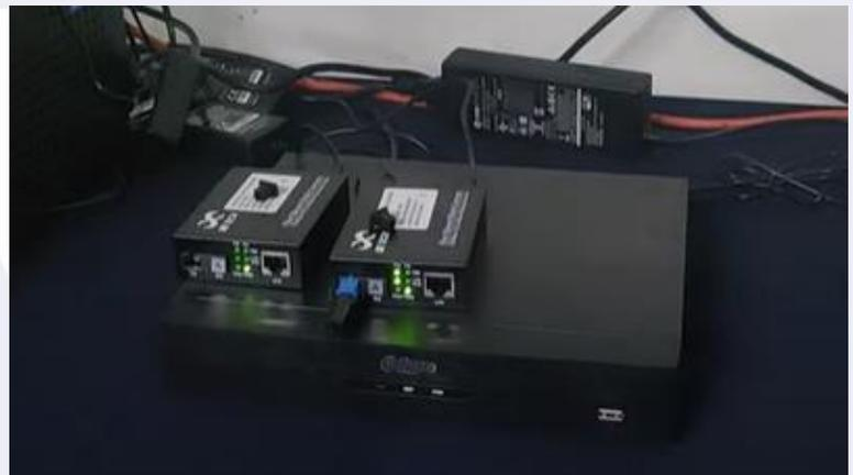
Despues se conecta del puerto UTP del Convertidor de Medios (B) al 2do Switch
