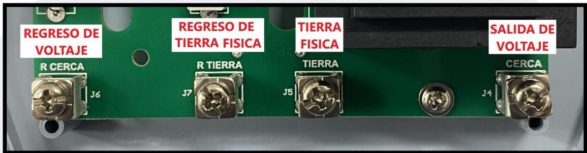
**Activación de la sirena:** Para activar la alarma del energizador y se accione la sirena, se debe de realizar un puente con cable bujía o doble aislado entre ambas terminales de tierra física y salida del alto voltaje del energizador, con esto se simula que hay un corte en la línea.
