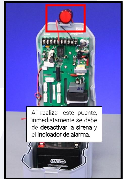
Esto indica que el energizador no solo cumple su función de alarma, sino que también está libre de fallas en las terminales de salida de alto voltaje y tierra física. Las pruebas realizadas confirman que el energizador opera correctamente y se alimenta adecuadamente de las fuentes de voltaje de corriente alterna y continua.
