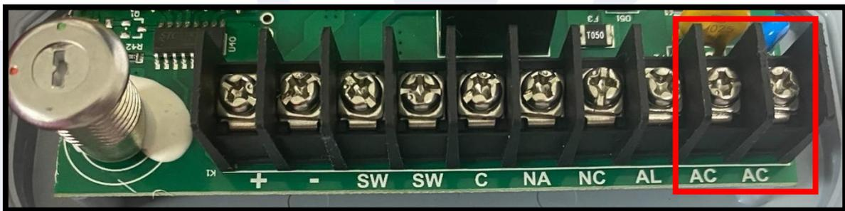
Esta medición debe darnos un resultado de **110- 220 VCA** que corresponde a la alimentación convencional en un recinto. Para realizar esta medición hay que asegurarnos que el multímetro se encuentre en modo de lectura de corriente alterna ( $V\sim$ ).
