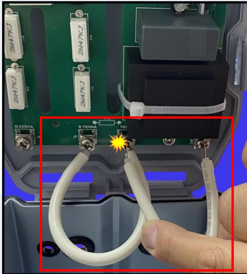
Esta prueba al generar el arco durante 10 segundos se debe de activar la alarma del energizador habilitando la sirena y en cuanto se deje de generar el arco, se desactivará alarma ya que el circuito cierra el sistema.
