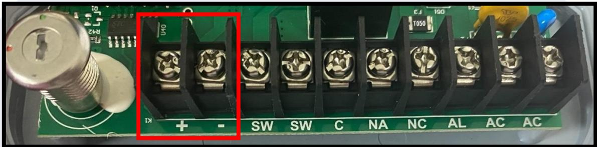
Esta medición debe darnos un resultado de **12-14 VCD** que corresponde a la fuente de alimentación interna del dispositivo. Para realizar esta medición hay que asegurarnos que el multímetro se encuentre en modo de lectura de corriente directa (**V—**), tener en cuenta que la terminal **1** corresponde al **positivo** y la terminal **2** al **negativo** de la alimentación.
