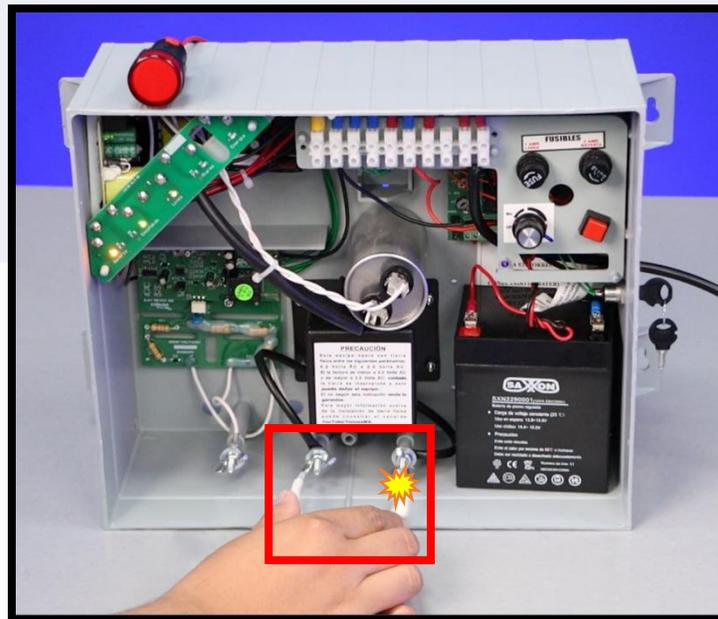
Esta prueba al generar el arco durante 10 segundos se debe de activar la alarma del energizador habilitando la sirena y en cuanto se deje de generar el arco, se desactivará alarma ya que el circuito cierra el sistema.
