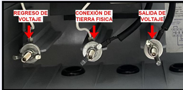
**Activación de la sirena:** Para activar la alarma del energizador y se accione la sirena, se debe de realizar un puente con **cable bujía o doble aislado** entre las terminales de **tierra física** y **salida del alto voltaje** del energizador, con esto se simula que hay un corte en la línea.
