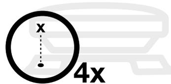
5. Fixez l'ensemble à l'aide de quatre vis en acier inoxydable n° 12 en acier inoxydable 316 (non fournies).
