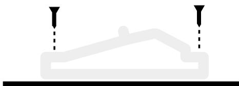
4. Rattachez l'interrupteur à la base et appuyez dessus pour le fixer.
