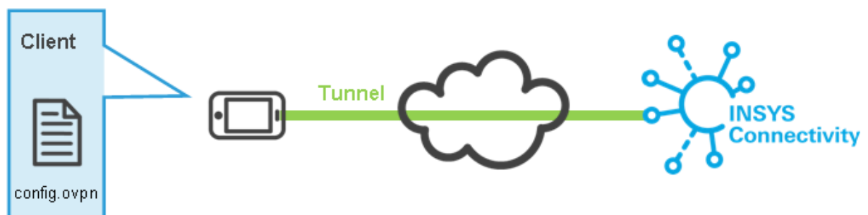
Abbildung 1: Android Tablet mit INSYS Connectivity Service über OpenVPN
