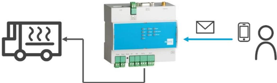
Abbildung 1: Schalten eines Ausgangs per SMS – Übersicht
